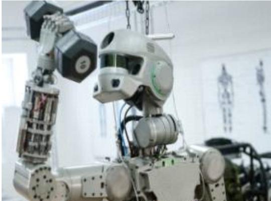
러시아 미래연구재단 산하 국립 로봇공학 기술기 초요소개발센터는 러시아가 2022년 발사 예정인 신형 유인우주선 페데라치야에 로봇을 탑승시켜 시험 비행을 진행할 계획을 가지고 있으며, 이를 위해 휴머노이드 로봇 'FEDOR(Final Experimental Demonstration Object Research)'를 제작 중이라고 밝힘.
